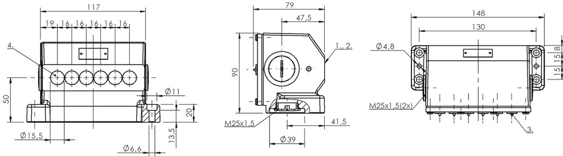
1) Опорная кромка 2) Активная поверхность 3) Функциональный индикатор FD/FE/LL 4) 1-я точка коммутации
