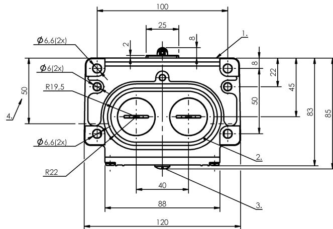
1) Опорная кромка 2) Уплотнительное кольцо 3) Функциональный индикатор FD/FE/LL 4) Кабельный ввод 5) Марк. Предохр. точка коммутации
