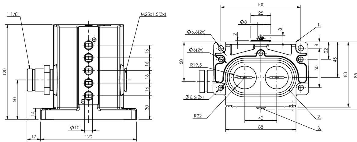
1) Опорная кромка 2) Уплотнительное кольцо 3) Функциональный индикатор FD/FE/LL
