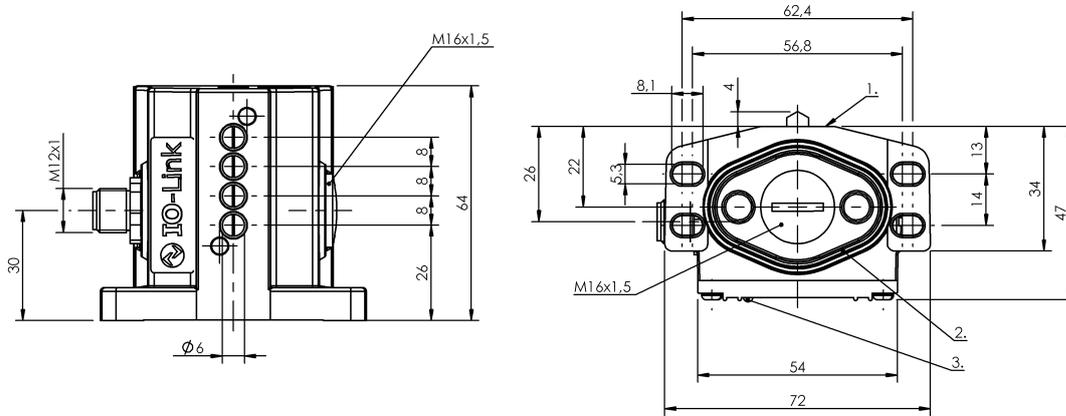
1) Опорная кромка 2) Уплотнительное кольцо 3) Функциональный индикатор FC
