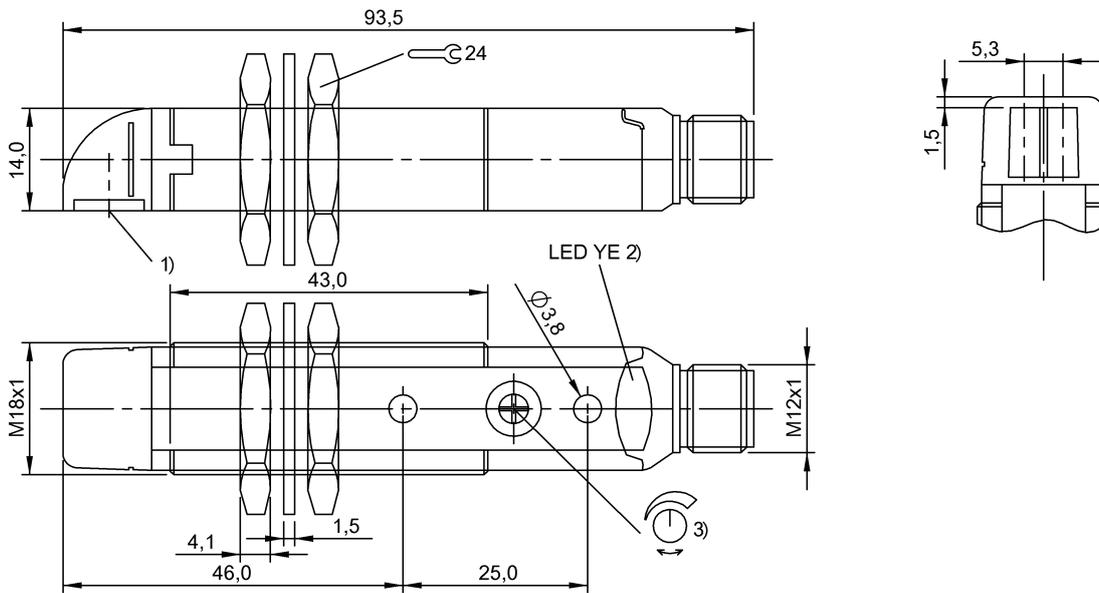
1) Оптическая ось 2) Функция выхода 3) Sn
