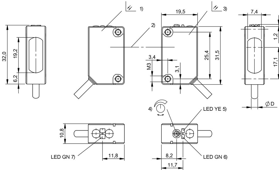
1) Передатчик 2) Оптическая ось 3) Приемник 4) Чувствительность 5) Функция выхода 6) Стабильность 7) Напряжение питания
