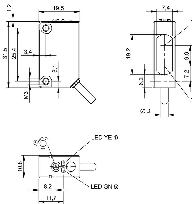
1) Оптическая ось, приемник 2) Оптическая ось, передатчик 3) Sn 4) Функция выхода 5) Стабильность
