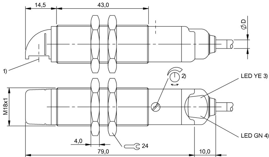
1) Оптическая ось 2) Sn 3) Функция выхода 4) Напряжение питания
