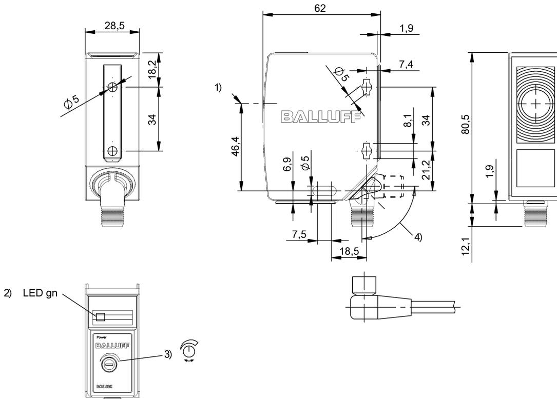
1) Оптическая ось, передатчик 2) Напряжение питания 3) Sn 4) Поворачивается на 270°
