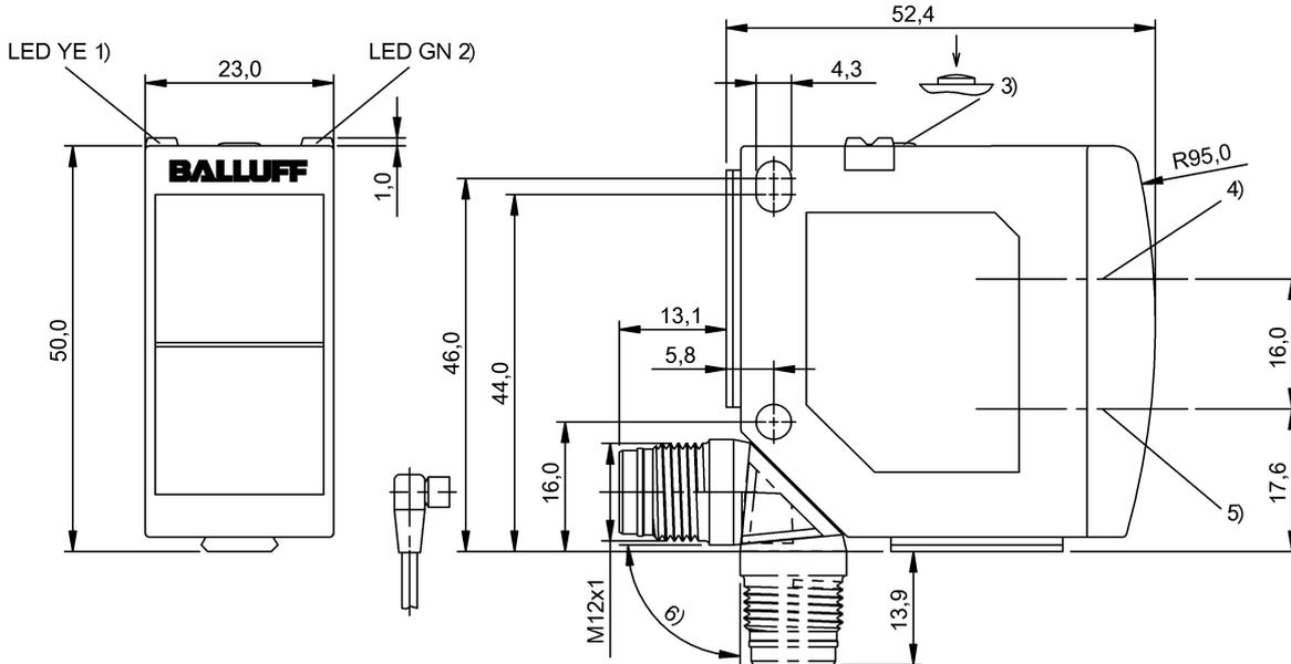
1) Функция выхода / сбой 2) Напряжение питания / режим настройки 3) Sn, светл./темн. 4) Оптическая ось, приемник 5) Оптическая ось, передатчик 6) Поворачивается на 270°
