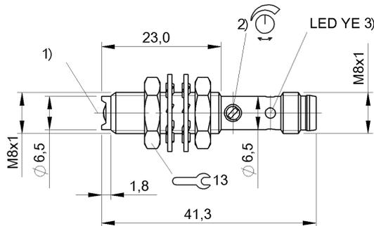
1) Оптическая ось 2) Sn 3) Функция выхода
