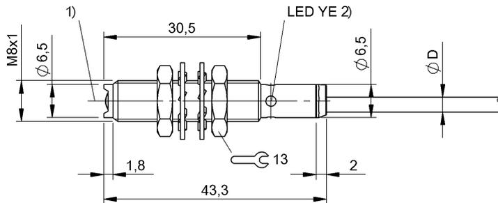
1) Оптическая ось 2) Функция выхода
