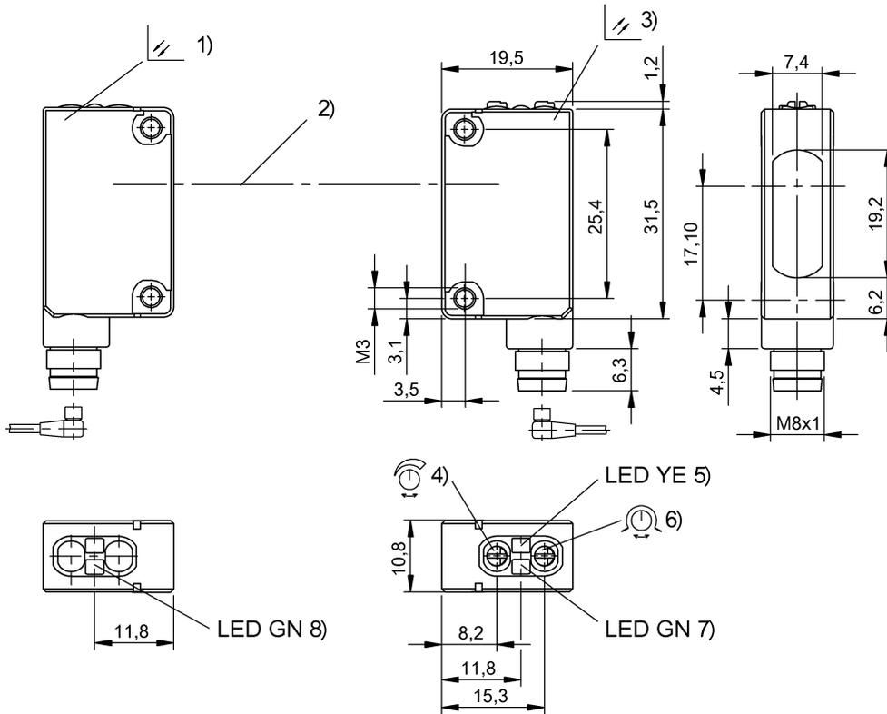
1) Передатчик 2) Оптическая ось 3) Приемник 4) Чувствительность 5) Функция выхода 6) Включение при освещении / затемнении 7) Стабильность 8) Напряжение питания
