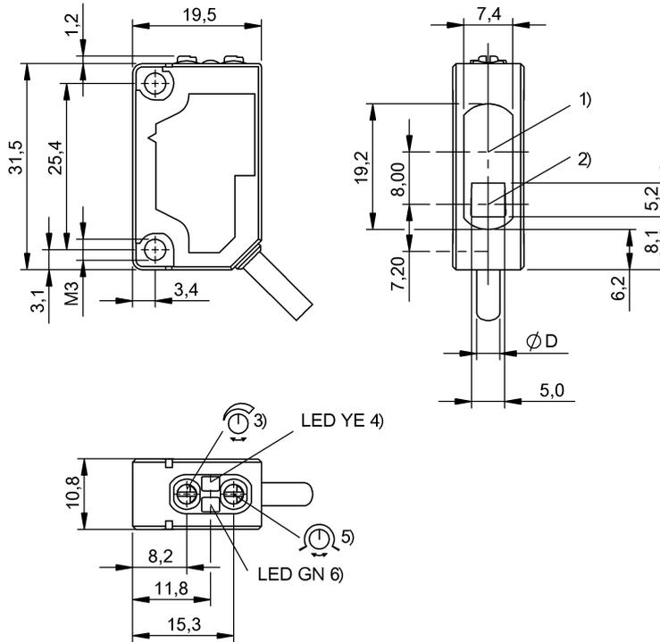
1) Оптическая ось, приемник 2) Оптическая ось, передатчик 3) Чувствительность 4) Функция выхода 5) Включение при освещении / затемнении 6) Стабильность
