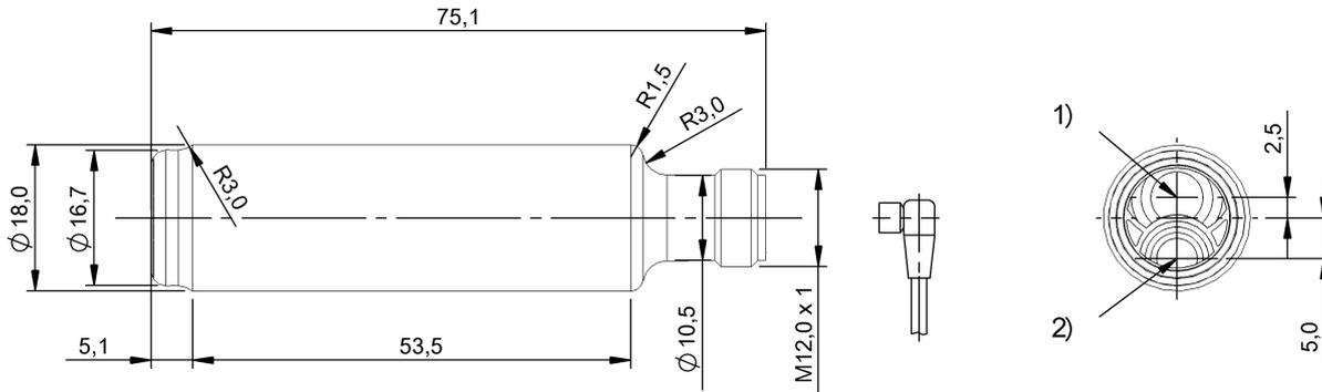
1) Оптическая ось, приемник 2) Оптическая ось, передатчик
