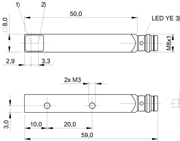
1) Оптическая ось, передатчик 2) Оптическая ось, приемник 3) Функция выхода
