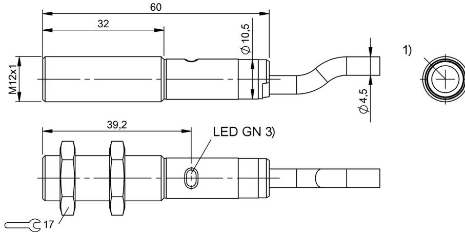
1) Оптическая ось, передатчик 3) Напряжение питания
