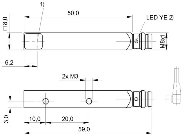
1) Оптическая ось, приемник 2) Функция выхода
