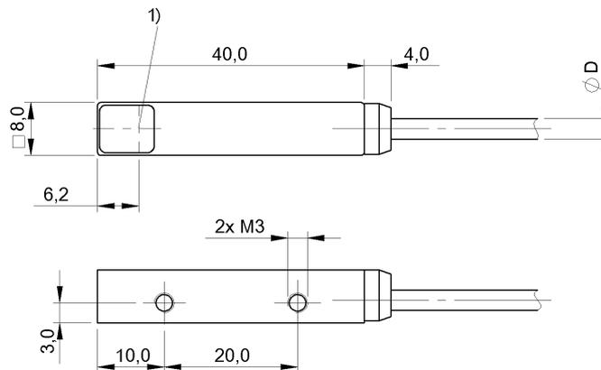
1) Оптическая ось, передатчик
