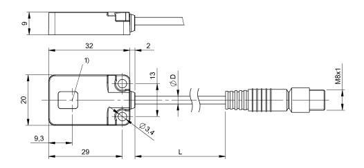
1) Оптическая ось, передатчик
