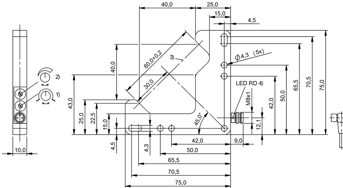
1) Включение при освещении / затемнении 2) Чувствительность 3) Оптическая ось 4) Функция выхода
