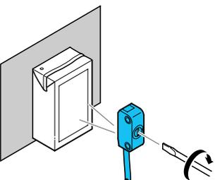
Tastweite durch Drehen des Potentiometers im Uhrzeigersinn weiter erhöhen bis Funktionsreserve-LED (grün) Dauersignal anzeigt.
