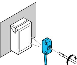
Empfindlichkeitspotentiometer im Uhrzeigersinn drehen bis Signaländerung erfolgt, LED (gelb) Dauersignal.
