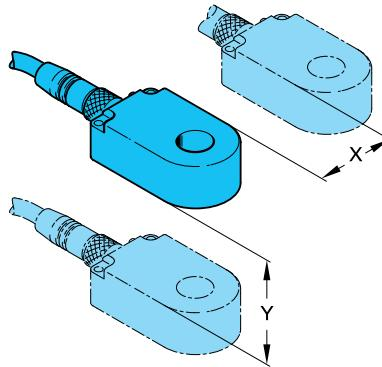
Metallische Abschirmbleche, die zwischen den Ringsensoren positioniert werden, können die Mindestmontageabstände erheblich reduzieren. Besonders gut eignet sich Aluminiumblech. Die Abschirmwirkung steigt mit der Größe und Stärke des Abschirmblechs. Eine unempfindlichere Einstellung wirkt sich ebenfalls positiv auf den Mindestmontageabstand aus.
