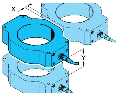
Metallische Abschirmbleche, die zwischen den Ringsensoren positioniert werden, können die Mindestmontageabstände erheblich reduzieren. Besonders gut eignet sich Aluminiumblech. Die Abschirmwirkung steigt mit der Größe und Stärke des Abschirmblechs. Eine unempfindlichere Einstellung wirkt sich ebenfalls positiv auf den Mindestmontageabstand aus.
