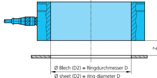
Durchgangsbohrung Blech (D2) = Ringdurchmesser D:
