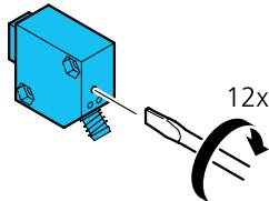
Potentiometer 12 Umdrehungen im Uhrzeigersinn auf max. Reichweite drehen.
