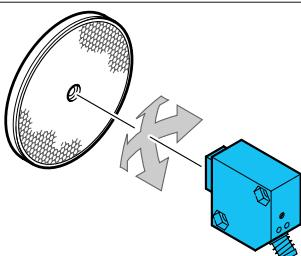
ORV 30 ... auf den Reflektor ausrichten bis beide LEDs (grün und gelb) Dauersignal anzeigen.
