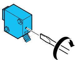
Potentiometer im Uhrzeigersinn drehen bis der ORV 30 ... schaltet und beide LEDs Dauersignal anzeigen.
