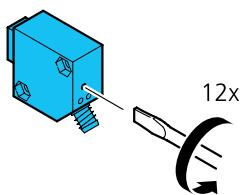
Potentiometer 12 Umdrehungen gegen den Uhrzeigersinn auf min. Reichweite zurückdrehen bis Signaländerung erfolgt und beide LEDs aus sind.
