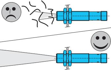
Die Wandleroberfläche sowie der Bereich der Detektionskeule ist zwingend frei zu halten. Es ist darauf zu achten, dass keinerlei störende Objekte zwischen dem Sensor und dem Zielobjekt innerhalb der Keule sind.
