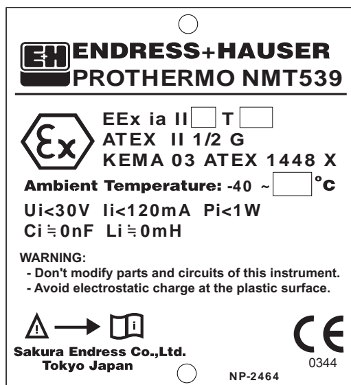
Рис. 2 Информация на паспортной табличке Prothermo NMT 539 с аттестацией ATEX.
