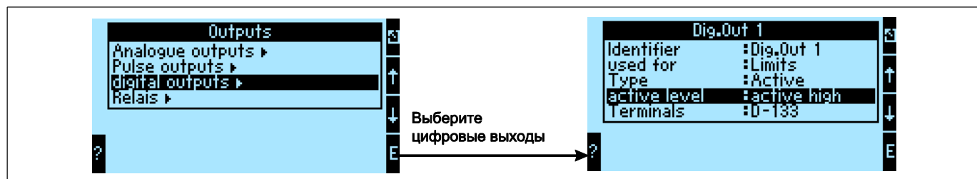
Рис. 45: Настройка цифровых выходов
