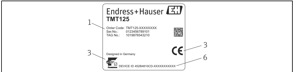
Abb. 2: Typenschild auf dem Feldgehäuse (Beispiel)
