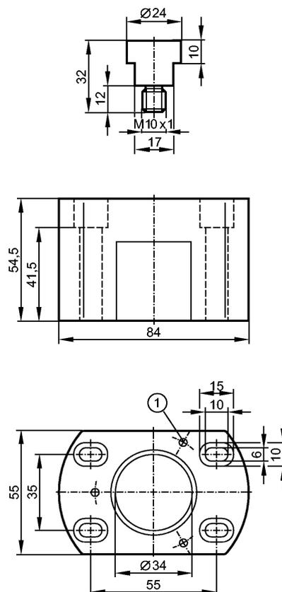
1: буровая скважина для крепления датчика положения клапанов на адаптере
