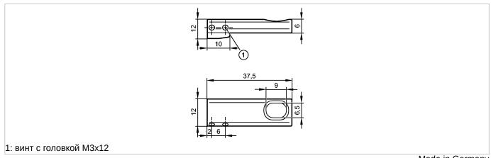
Made in Germany Характеристики Защитный адаптер для датчиков цилиндров под Т-образный паз Механические данные Исполнение для типов МКТ (датчики цилиндров с Т-слотом) отливка из цинка (покрытие); винты: нерж.сталь Материал Bec [kg] 0,01 Принадлежности Принадлежности (входят в комплект) 2 винта с внутренним шестигранником; SW 1,5 Примечания Упаковочная величина [штука]
