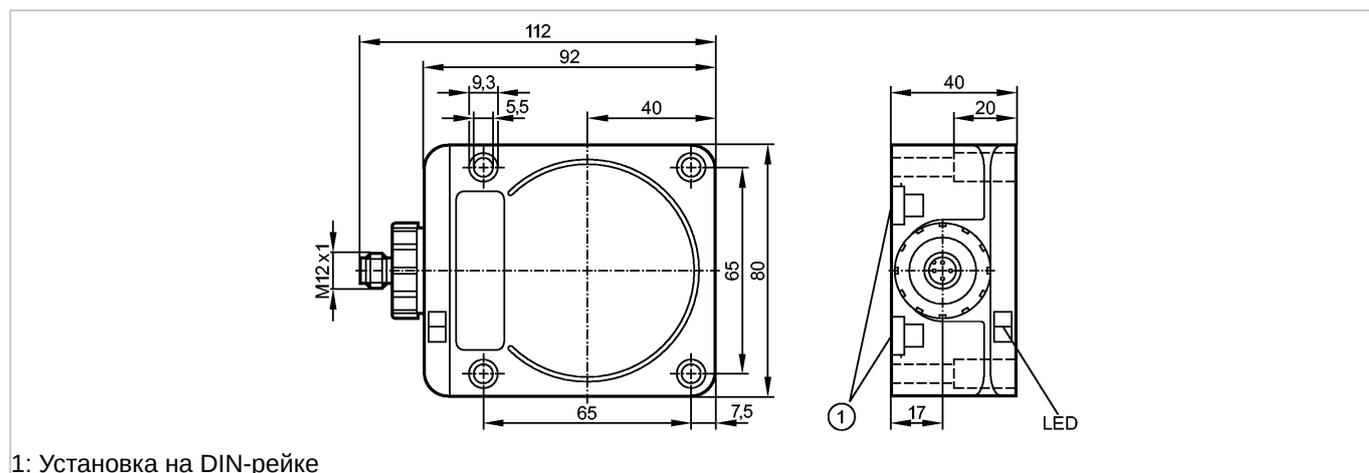
1: Установка на DIN-рейке
