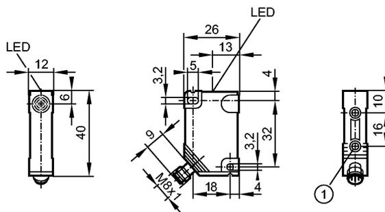
1: Соединительная втулка, резьба М3, глубина 5,8 мм, макс. момент затяжки 1,2 Нм (крепежный винт тип 8.8), если латунная втулка в контакте с ответной частью
