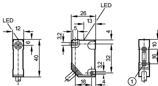
1: Соединительная втулка, резьба M3, глубина 5,8 мм, макс. момент затяжки 1,2 Нм (крепежный винт тип 8.8), если латунная втулка в контакте с ответной частью
