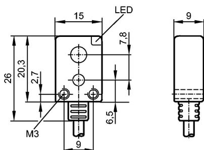
Приёмник за верхней линзой, излучатель за нижней линзой
