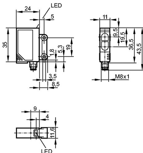
Приёмник за верхней линзой, излучатель за нижней линзой
