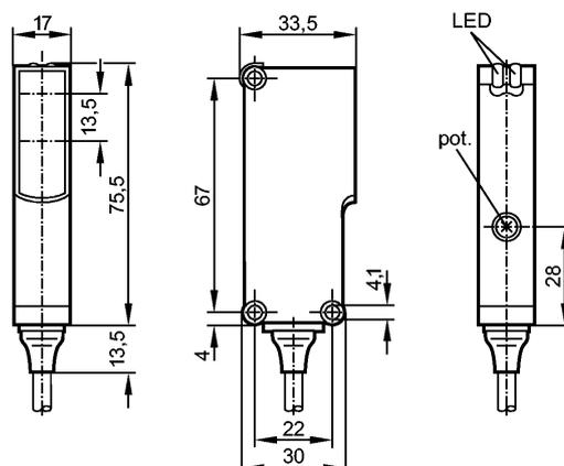
Приёмник за нижней линзой, Излучатель за верхней линзой
