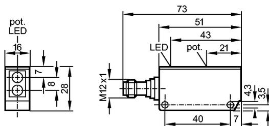
Приёмник за верхней линзой, излучатель за нижней линзой
