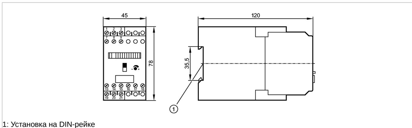
1: Установка на DIN-рейке
