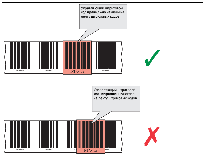
Рис. 6.6: Правильное расположение управляющего штрихового кода
