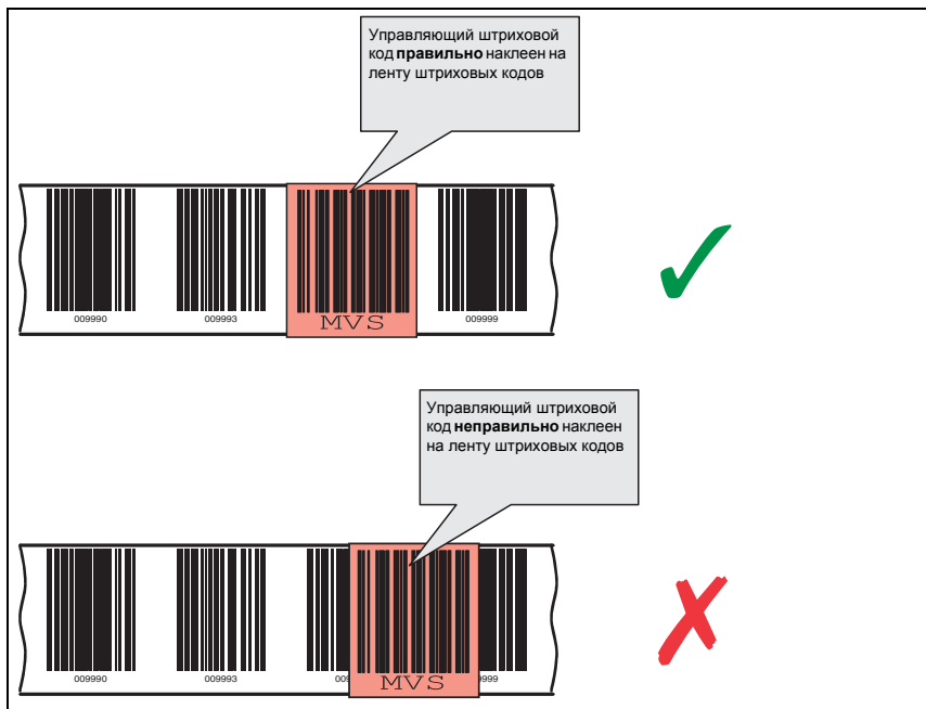
Рис. 6.6: Правильное расположение управляющего штрихового кода
