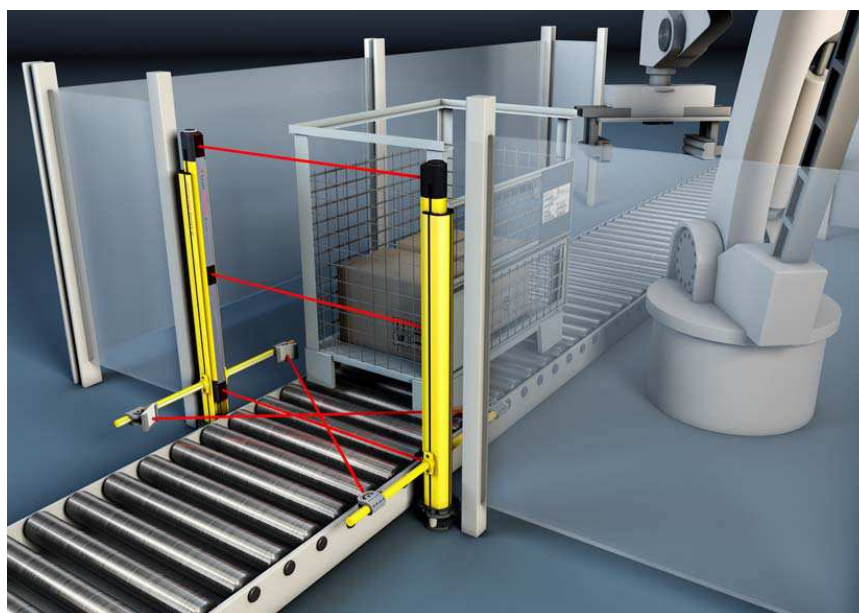
Рис. 5.2: 3-лучевая защита с системой приемопередачи при использовании робота для укладки грузов на поддоны
