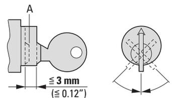
(en) Removing the key and locking wheel ① – (de) Abziehbarkeit des Schlüssels und Sperrrad ① – (fr) Possibilité de retrait de la clé et roue de blocage ① –
