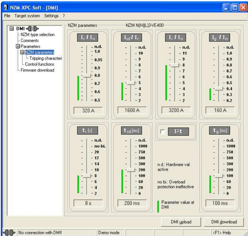
Figure 51: NZM parameters
