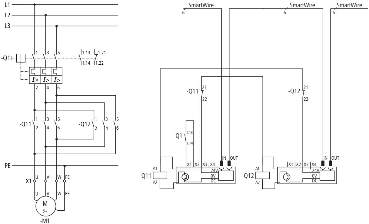
Figura 13: Schema elettrico teleinvertore in combinazione con DILM12-XEV
