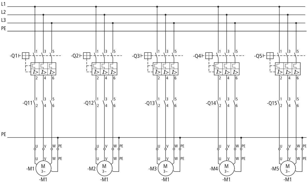
Figura 17: Circuito principale per disinserzione di sicurezza
