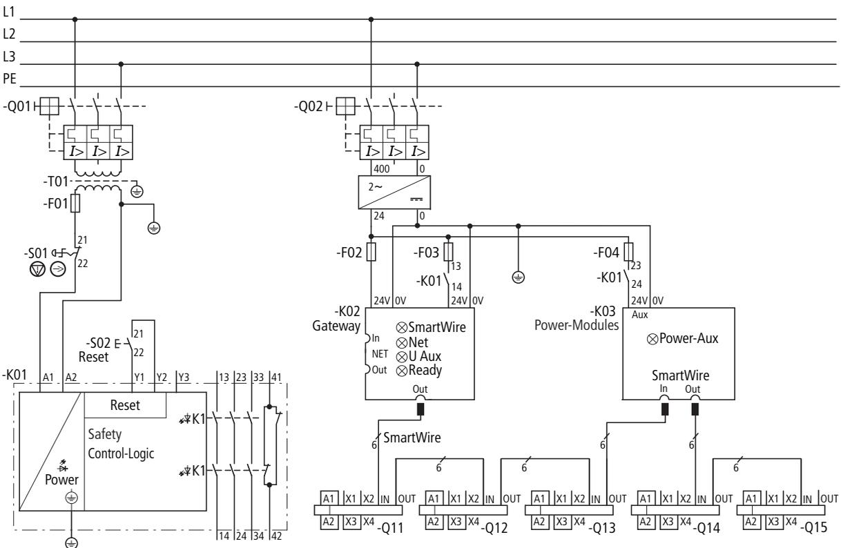
Figura 16: Circuito di alimentazione per distensione di sicurezza
