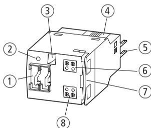
Figura 2: Struttura modulo SmartWire per DILM: DILM
