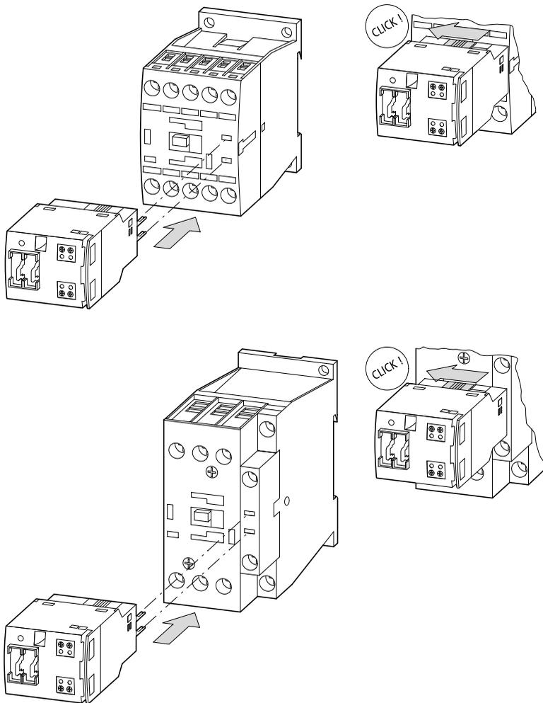
Figura 8: Montaggio modulo SmartWire per DILM e contattore
