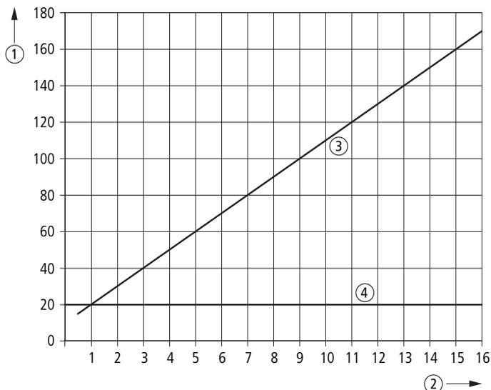
Figura 5: tempo di reazione sistema SmartWire (Worst Case)
