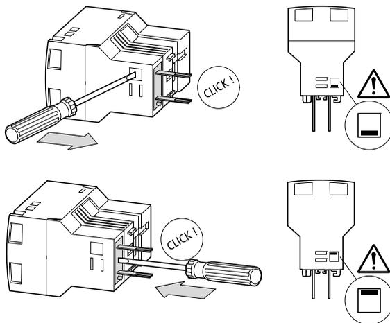
Figura 7: Regolazione modulo SmartWire per DILM e contattore
