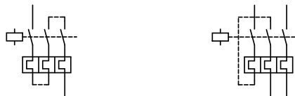
Abbildung 6: Verdrahtung des Motorschutzschalters PKE für den Schutz von Wechselstrommotoren (Reihenschaltung der Überlastauslöser)
