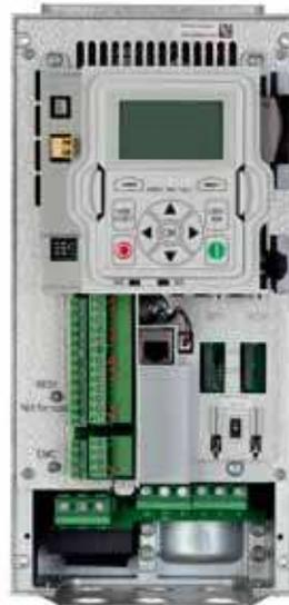
6. Effectuer le câblage des bornes d'alimentation (L1, L2, L3), moteur (U, V, W), et terre selon la **Figure 19**. Il est recommandé d'acheminer séparément les câbles d'alimentation et moteur.
