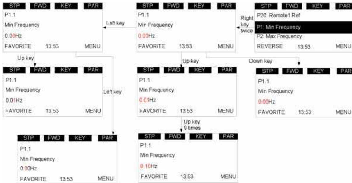
Figure 25. Modifier valeur de paramètre
