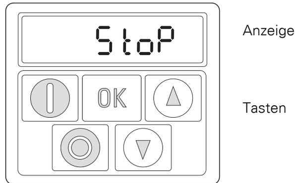
Abbildung 1: Ansicht der Bedieneinheit
